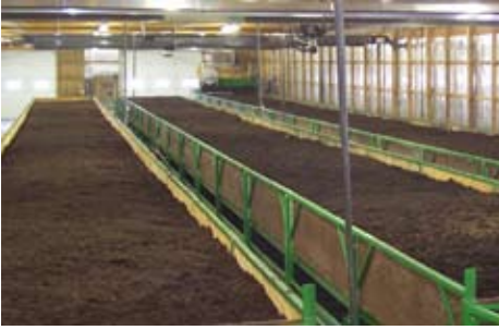
Şekil 3, Ön Kompostlaştırma ve reaktör üretim süreci
