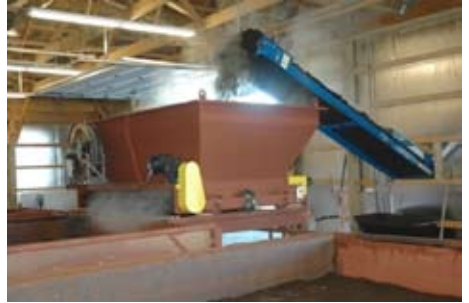
Şekil 4, Reaktör iskeleti ve raylı sistem ile solucanlara gıdanın günlük olarak dağıtılması
