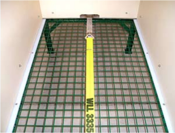
Şekil 4, Reaktör iskeleti ve raylı sistem ile solucanlara gıdanın günlük olarak dağıtılması
