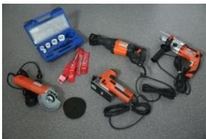
**RC 5:** Der erfahrene Täter setzt zusätzlich Elektrowerkzeuge wie z. B. Bohrmaschine, Stich- oder Säbelsäge und Winkelschleifer ein. Mindestens 15 Minuten muss das Bauteil dem standhalten.
