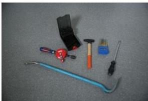
**RC 3:** Der Täter versucht zusätzlich mit einem zweiten Schraubendreher und einem Kuhfuß das Bauteil aufzubrechen. Es muss mindestens 5 Minuten standhalten.
