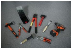
**RC4:** Der erfahrene Täter setzt zusätzlich Sägewerkzeuge und Schlagwerkzeuge wie Schlagaxt, Stemmeisen, Hammer und Meißel sowie eine Akku-Bohrmaschine ein. Dem muss das Bauteil mindestens 10 Minuten standhalten.
