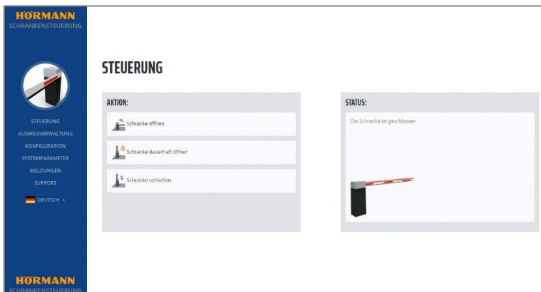
Bild 5: Mit der optionalen Anbindung über einen Web-Server können mehrere Schrankenanlagen zentral von einem Ort verwaltet werden. Zusätzlich ist eine Fernsteuerung und Statusabfrage möglich.
