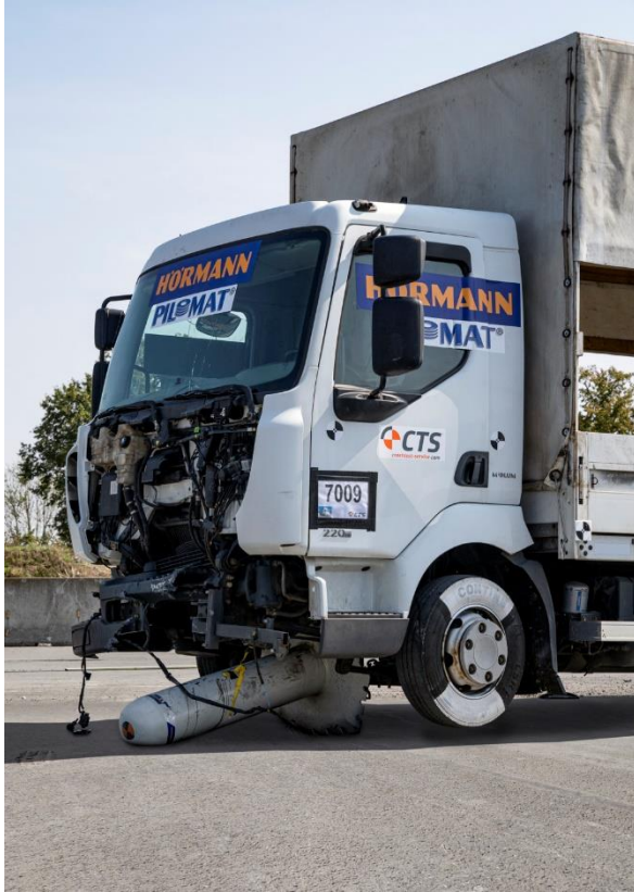
Bild 3: Bei einem Fahrzeugaufprall kippt der OktaBlock von Hörmann nach vorne, wobei sich die Grundplatte mit ihren Zacken zwischen Fahrzeug und Straßenoberfläche verkeilt, sodass das Fahrzeug nach kurzer Zeit zum Stehen kommt.
