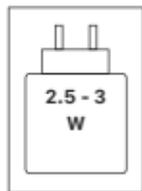
**Français** La puissance fournie par le chargeur doit se situer entre le minimum de 2.5 watts requis par l'équipement radio et le maximum de 3.0 watts permettant d'atteindre la capacité de charge maximale. Cet appareil est compatible avec la charge via USB-C et BC1.2, tel qu'indiqué dans les publications « USB Type-C® Cable and Connector Specification Release 2.3 » (en anglais) et
