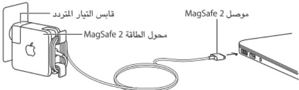
٠ وإذا كنت تستخدم سلك طاقة التيار المتردد، فوصله بمنفذ طاقة وضع محول الطاقة على سطح
