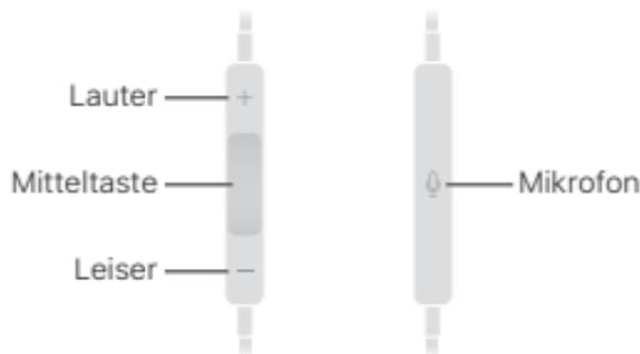
In den folgenden Anleitungen bedeutet ● ein schnelles Drücken der Mitteltaste und ■ das Drücken und Halten der Mitteltaste. Soll die Mitteltaste mehrfach gedrückt werden, achten Sie darauf, schnell nacheinander auf die Taste zu drücken.
