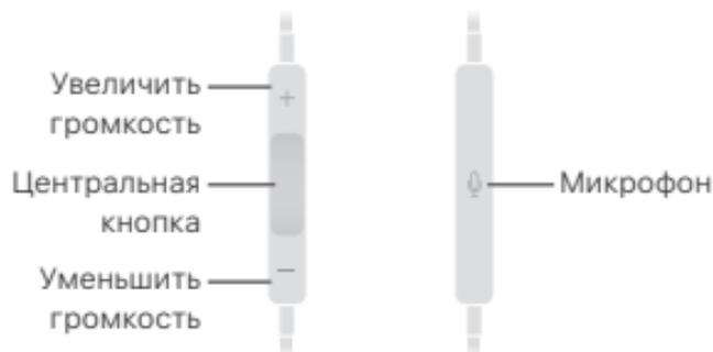
В данной инструкции значок ● обозначает быстрое нажатие центральной кнопки. Значок ■■ означает, что нужно нажать и удерживать центральную кнопку. Многократные нажатия должны быстро следовать друг за другом.
