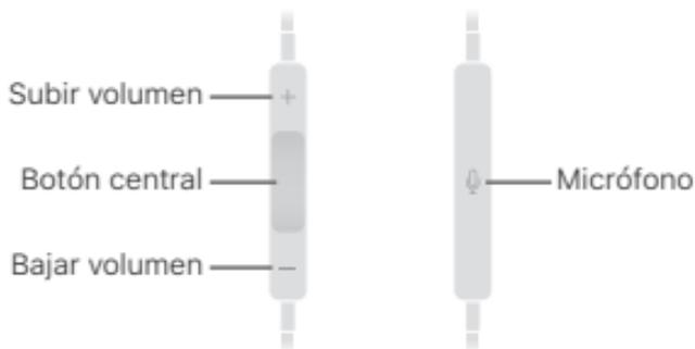
En las siguientes instrucciones, ● indica que se pulse rápidamente el botón central y ■■ indica que se mantenga pulsado el botón central. Cuando realice varias pulsaciones seguidas, asegúrese de que se sucedan rápidamente unas a otras.
