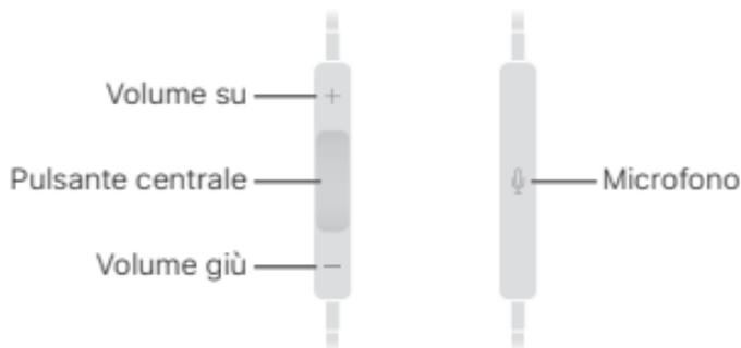
Nelle seguenti istruzioni, ● indica una pressione rapida del tasto centrale e ■■ indica una pressione prolungata del tasto centrale. Per le pressioni multiple, assicurati che si susseguano rapidamente.
