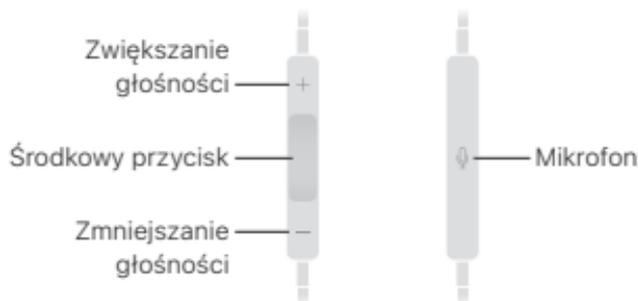
W poniższych instrukcjach ● oznacza szybkie naciśnięcie środkowego przycisku, a ■ oznacza naciśnięcie i przytrzymanie środkowego przycisku. Wykonując wiele naciśnień, upewnij się, że następują one szybko po sobie.
