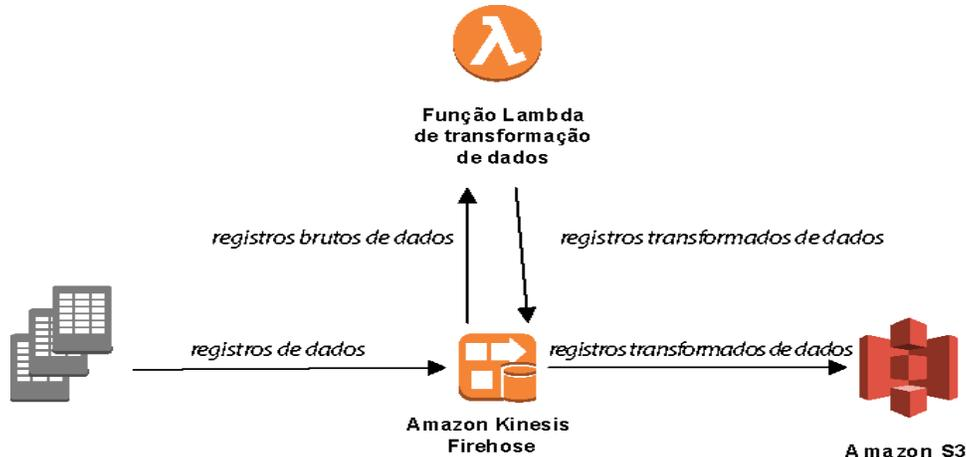
**Figura 2: Buffering de dados usando o Kinesis Firehose e funções Lambda**
