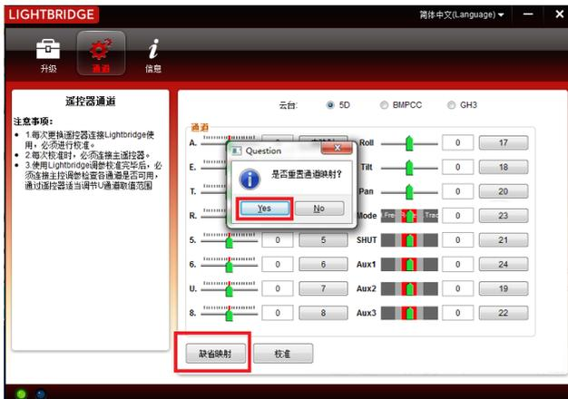
3. 如界面所示，调参软件将按默认顺序分配通道，左边 8 个通道为遥控器通道，右边 8 个通道为云台通道。由图可见，遥控器通道值未归中，需要校准。
