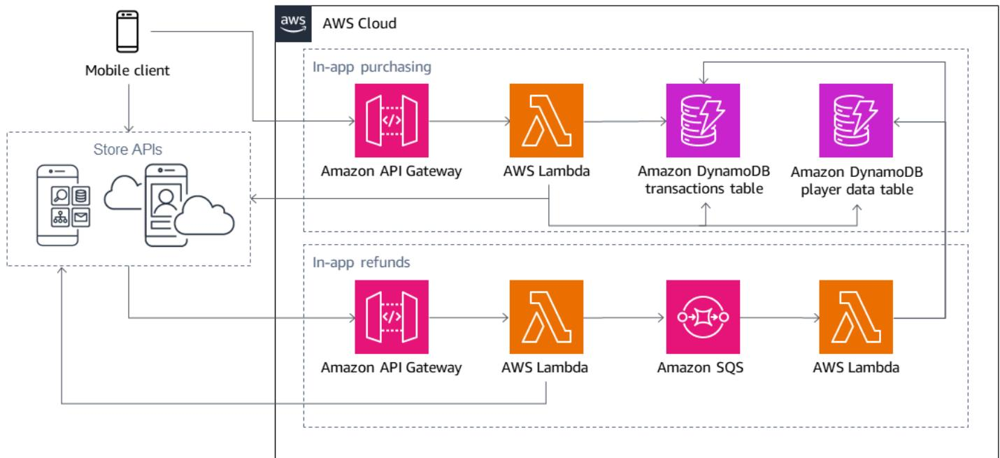
각 사용자 스토리는 코드 및 구성, 인프라, 데이터 저장소, 외부 종속성 등 4가지 공통 구성 요소로 구성됩니다. 디아어그램에는 이러한 구성 요소가 모두 포함되어야 하며 구성 요소 간의 상호 작용이 반영되어야 합니다. 예를 들어, Amazon API Gateway 엔드포인트에 과도한 부하가 발생하는 경우 해당 부수가 시스템의 다른 구성 요소 (예:)에 어떻게 캐스케이드되는지 생각해 보십시오. AWS Lambda 함수 또는 Amazon DynamoDB 테이블. 이러한 상호 작용을 추적하면 장애 모드가 사용자 스토리에 어떤 영향을 미칠 수 있는지 이해하는 데 도움이 됩니다. 이전 그림과 같이 데이터 흐름도를 사용하거나 아키텍처 디아어그램에서 간단한 흐름 화살표를 사용하여 이 흐름을 시각적으로 캡처할 수 있습니다. 각 구성 요소에 대해 전송되는 정보의 유형, 수신되는 정보, 통신이 동기식인지 비동기식인지 여부, 넘어가는
