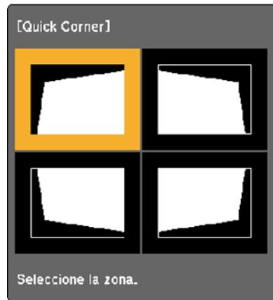
6. Use los botones de flecha del proyector o del control remoto para seleccionar la esquina de la imagen que desea ajustar. Luego, pulse el botón **↵ Enter**.
