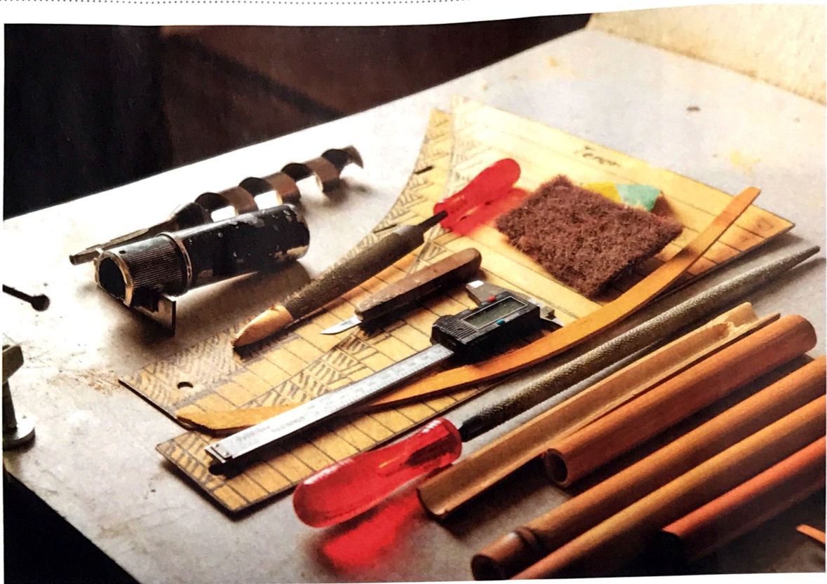
DIE WERKZEUGE DES MEISTERS Der Panflötenbauer braucht für seine Arbeit Feilen, Schnitzmesser, Schleifpapier, Poliertuch, Schäleisen, Bohrer, Formschablonen und Schieblehre. Jörg Frei arbeitet seit 1984 für Dajoeri Panflöten in Langnau am Albis.
