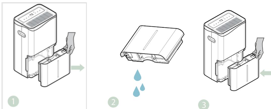
**Procédure :** Lorsque le réservoir est plein, l'appareil émet un signal sonore et le voyant "plein" (symbole de la goutte) s'allume.
