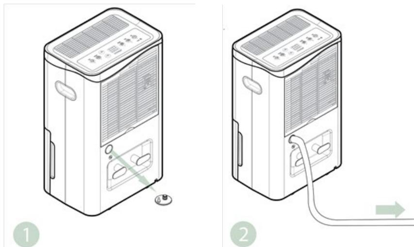
Si une évacuation est disponible, l'eau de condensation peut également être évacuée directement par un tuyau raccordé. L'unité n'a pas de pompe. Le drain doit donc être plus bas que le raccord du tuyau.
