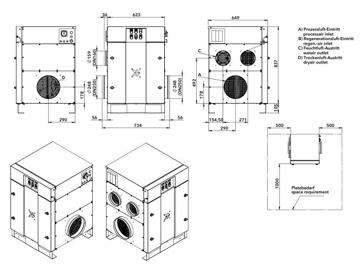
Änderungen vorbehalten. Alle Leistungsdaten beziehen sich auf 1013 mbar, eine Dichte von 1,2 k g/m³ und eine Spannungsversorgung mit 3x400 V/50Hz +PE bzw. 230V/50 Hz. Für ihre Projektauslegung empfehlen wir bzgl. der Entfeuchtungsleistung einen Sicherheitsabschlag je nach Anwendung in Höhe von 10-20 % zu berücksichtigen.
