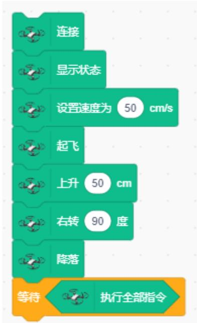
5. 点击代码模块即可启动程序，程序启动后会弹出 *connecting* 窗口对tello进行连接；当无人机连接成功，*connecting* 窗口会自动关闭，程序会依次执行；在每一次代码运行之前，*连接模块* 都会执行连接指令，确保tello与电脑的连接稳定性；
