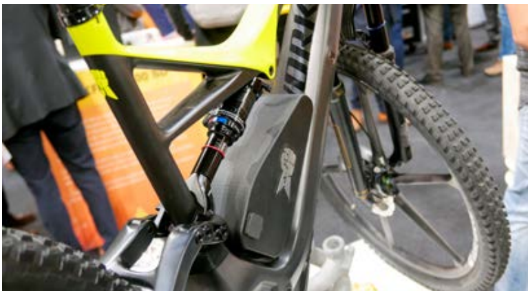
Deze behuizing voor een accu van een elektrische MTB wordt geprint op een van de negen HP printers van ZiggZagg.
