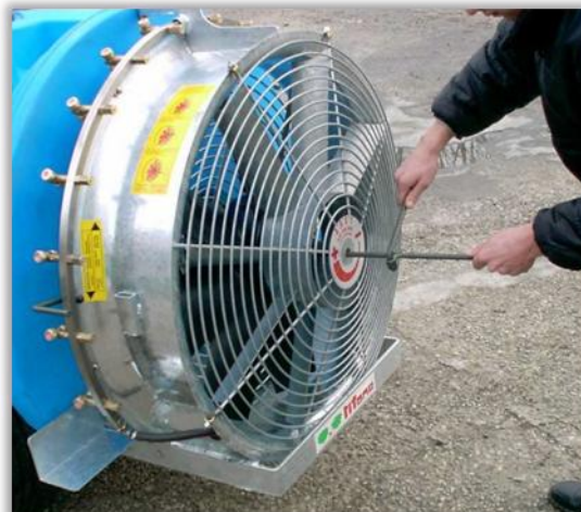
Regulacja wydajności wentylatora - kąt łopat wirnika
