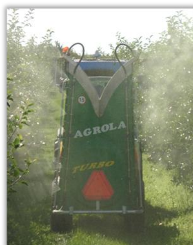
Wentylator osiowy z deflektorem - z odwróconym ciągiem
