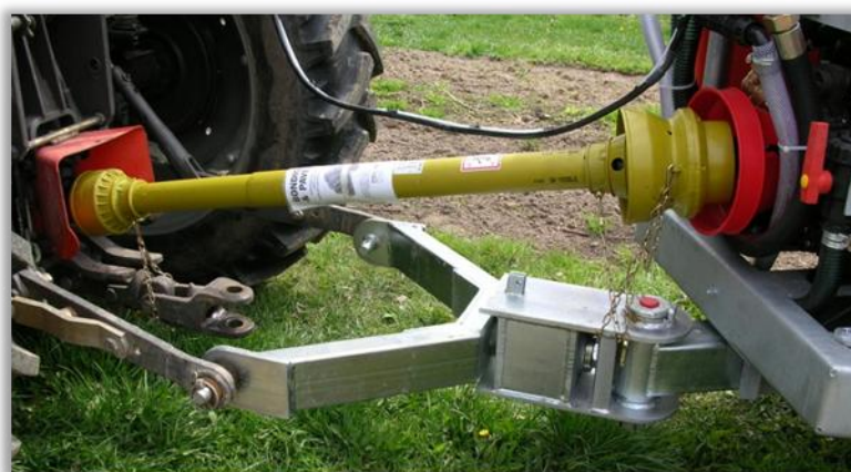
Zabezpieczenia zaczepek i wałka przegubowo-teleskopowego oryginalnymi sworzniami i zawleczkami
