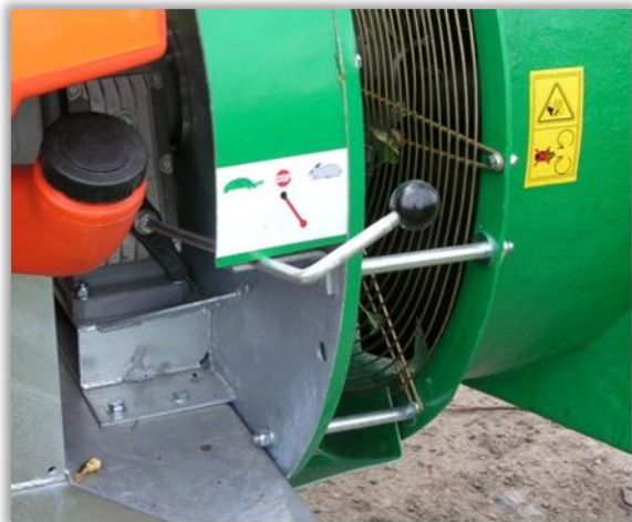
Zmiana wydajności wentylatora - przełożenie przekładni wentylatora
