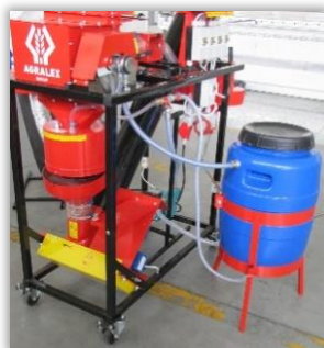
Rys. 17. Zbiornik zaprawy zamocowany na ramie zaprawiarki.
