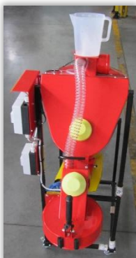
Rys. 17. Zbiornik zaprawy zamocowany na ramie zaprawiarki.
