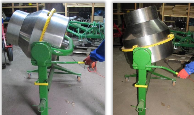
Rys. 94 i 95. Kontrola mechanizmu pochylania bębna w zaprawiarce porcjowej bębnowej.
