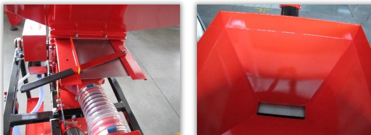
Rys. 38 i 39. Dźwignia przesłony i przesłona układu zasypowego nasion.
