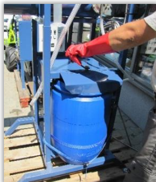
Rys. 26. Zbiornik zaprawy z pokrywą stojący na ramie zaprawiarki.
