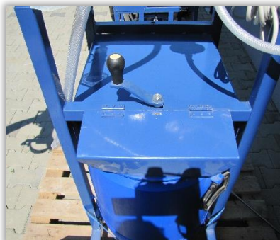
Rys. 98. Zbiornik zaprawy z ręcznym mieszadłem mechanicznym - widoczna korbka mieszadła.
