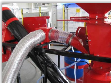
Rys. 67 i 68. Przewody przyłącza urządzenia odpylającego do komory odmierzania nasion i do urządzenia opróżniającego (68).
