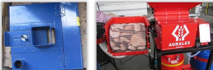
Rys. 40. Przesłona układu zasypowego nasion.
