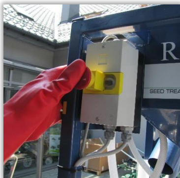
Rys. 42. Wyłącznik bezpieczeństwa układu elektrycznego.
