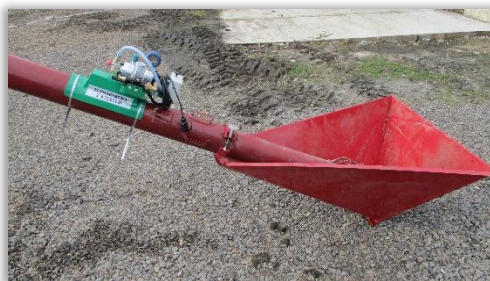
Rys. 80. Zaprawiarka montowana na przenośniku ślimakowym do zboża (podawanie zaprawy i zraszanie ciśnieniowe).
