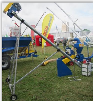
Rys. 5 i 6. Zaprawiarka montowana na przenośniku ślimakowym do zboża.
