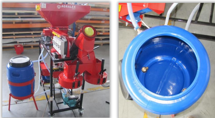
Rys. 96 i 97. Zbiornik zaprawy z przewodem powrotu zaprawy spełniającym rolę mieszadła.
