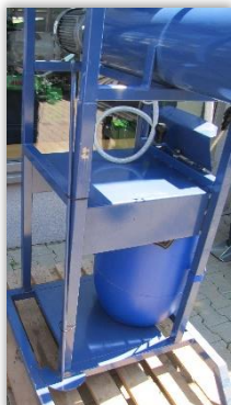
Rys. 17. Zbiornik zaprawy zamocowany na ramie zaprawiarki.
