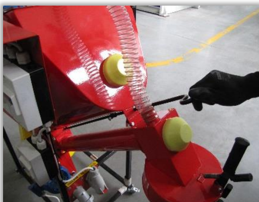
Rys. 91. Kontrola działania zasowy opróżniania komory mieszania.
