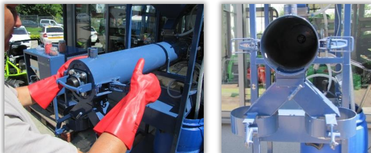
Rys. 76 i 77. Komora mieszania: sposób zamknięcia (76) i strefa opróżniania.
