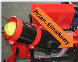
Rys. 85. Komora mieszania ze znajdującym się w jej wnętrzu (tu niewidocznym) przenośnikiem ślimakowym zaprawiarki przepływowej.
