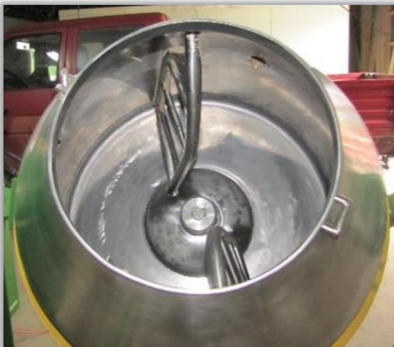
Rys. 9. Mieszadła zaprawiarki bębnowej (widok przez otwór zasypowy).
