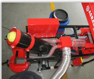
Rys. 67 i 68. Przewody przyłącza urządzenia odpylającego do komory odmierzania nasion i do urządzenia opróżniającego (68).
