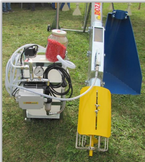
Rys. 48. Zaprawiarka z ciśnieniowym podawaniem zaprawy – manometr powinien być widoczny z miejsca operatora..
