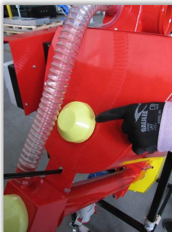
Rys. 13 i 14. Pasek napędowy zaprawiarki bębnowej (po lewej) i osłonięte łożysko mieszadła zaprawiarki (po prawej).
