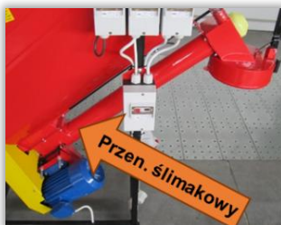
Rys. 85. Komora mieszania ze znajdującym się w jej wnętrzu (tu niewidocznym) przenośnikiem ślimakowym zaprawiarki przepływowej.
