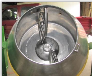
Rys. 100 i 101. Mieszadła o obłym kształcie we wnętrzu bębna zaprawiarki porcjowej.
