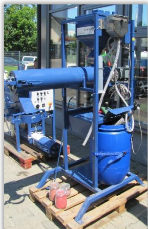
Rys. 11 i 12. Zaprawiarki przepływowe stosowane do zaprawiania zaprawą w formie płynnej.
