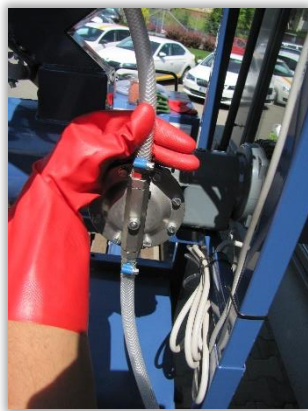
Rys. 51. Przewody cieczowe łączące układ czerpakowy ze zbiornikiem zaprawy.
