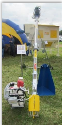
Rys. 32 i 33. Zaprawiarka montowana na przenośniku ślimakowym do zboża - podawanie zaprawy i zraszanie ciśnieniowe.
