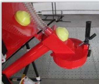
Rys. 89. Układ wylotowy zaprawiarki z workownicą dwudrożną.
