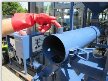
Rys. 65. Przyłącze urządzenia odpylającego w miejscu opróżniania komory.
