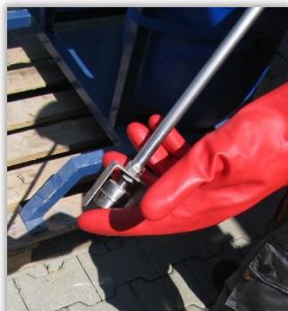
Rys. 46. Czujnik poziomu zaprawy umożliwiający zatrzymanie podawania nasion przy braku zaprawy.
