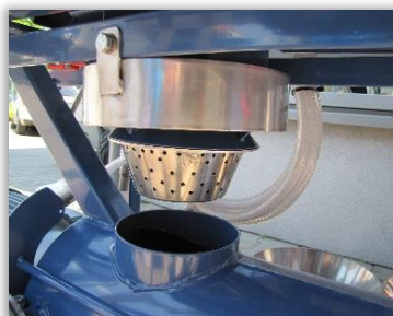
Rys. 53 i 54. Komora zraszania zaprawiarki przepływowej z otwartą osłoną (53) i ze zdemontowaną osłoną (54).
