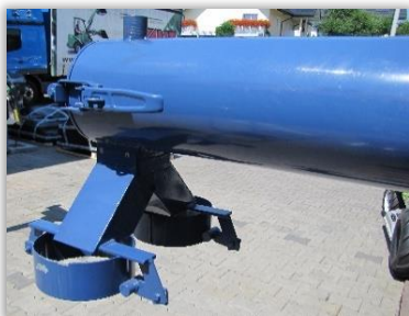
Rys. 89. Układ wylotowy zaprawiarki z workownicą dwudrożną.
