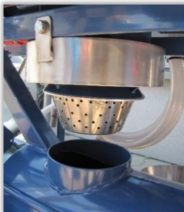
Rys. 74 i 75. Komory zraszania z rotacyjnym elementem zraszającym: uchylona osłona (74) i wnętrze komory po zdjęciu osłony (75).
