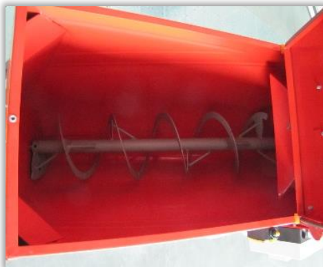
Rys. 16. Przenośnik ślimakowy zaprawiarki porcjowej pełniący funkcję mieszadła.
