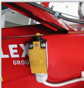
Rys. 42. Wyłącznik bezpieczeństwa układu elektrycznego.
