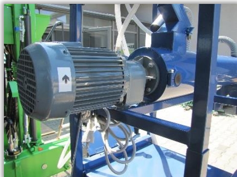
Rys. 15. Silnik napędu mieszadła zaprawiarki.
