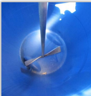
Rys. 98. Zbiornik zaprawy z ręcznym mieszadłem mechanicznym - widoczna korbka mieszadła.
