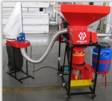
Rys. 61 i 62. System odpylania współpracujący z zaprawiarką porcjową (61) i przepływową (62).
