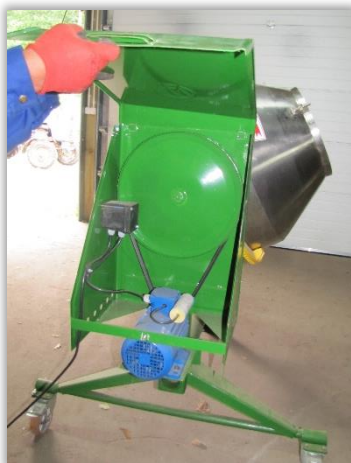
Rys. 13 i 14. Pasek napędowy zaprawiarki bębnowej (po lewej) i osłonięte łożysko mieszadła zaprawiarki (po prawej).
