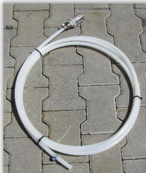
Rys. 57. Filtr ssawny z elastycznym przewodem cieczowym.
