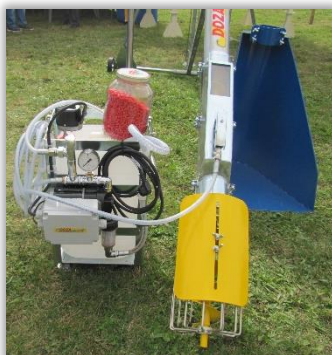
Rys. 5 i 6. Zaprawiarka montowana na przenośniku ślimakowym do zboża.
