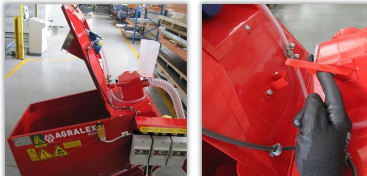
Rys. 24 i 25. Zamykana komora mieszania zaprawiarki porcjowej z rotacyjnym zraszczem (24) oraz jej zabezpieczenie w pozycji otwartej (25).
