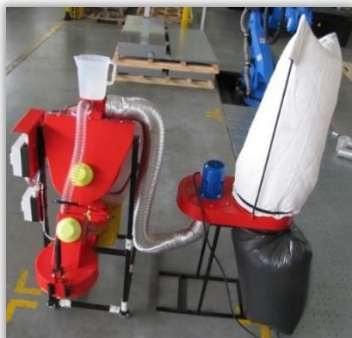
Rys. 61 i 62. System odpylania współpracujący z zaprawiarką porcjową (61) i przepływową (62).
