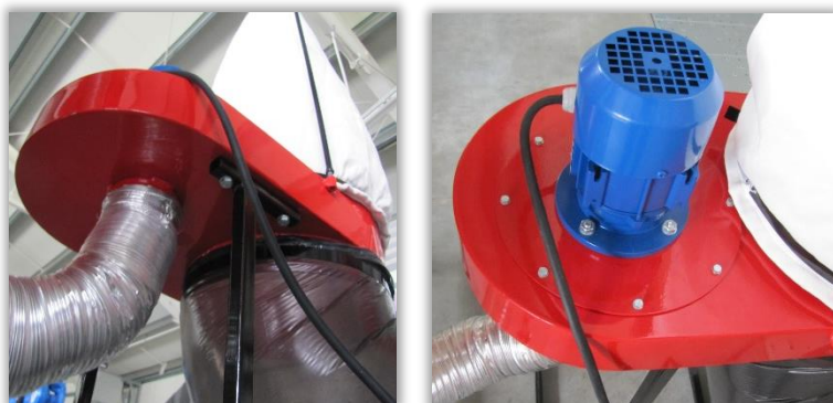
Rys. 71 i 72. Obudowa wentylatora urządzenia odpylającego – widok od dołu (71) i od góry (72) z silnikiem napędzającym wentylator.
