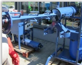
Rys. 87. Przenośnik ślimakowy wyjmowany z układu wylotowego zaprawiarki.
