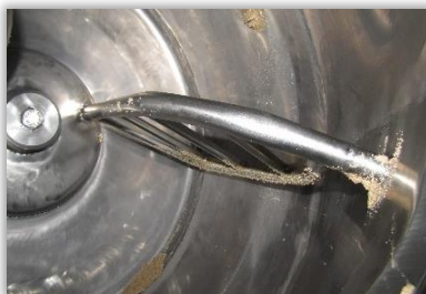
Rys. 100 i 101. Mieszadła o obłym kształcie we wnętrzu bębna zaprawiarki porcjowej.
