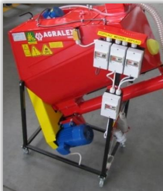
Rys. 20. Koło jezdne z blokadą - zaprawiarka porcjowa bębnowa.
