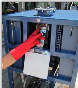
Rys. 44. Miejsce zamontowania bezpiecznika wyłączającego przepływ zaprawy.
