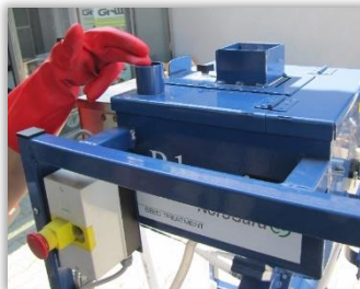
Rys. 65. Przyłącze urządzenia odpylającego w miejscu opróżniania komory.
