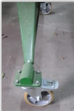
Rys. 20. Koło jezdne z blokadą - zaprawiarka porcjowa bębnowa.
