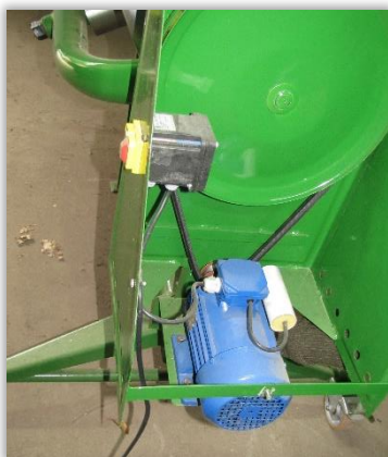
Rys. 22 i 23. Silnik elektryczny napędzający bęben zaprawiarki bębnowej (22), lub napędzający rozpylacz rotacyjny zaprawiarki porcjowej (23).
