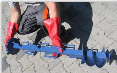
Rys. 87. Przenośnik ślimakowy wyjmowany z układu wylotowego zaprawiarki.
