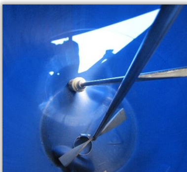
Rys. 46. Czujnik poziomu zaprawy umożliwiający zatrzymanie podawania nasion przy braku zaprawy.
