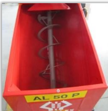
Rys. 55. Komora zraszania zaprawiarki przepływowej z częściowo zdemontowaną dolną osłoną.
