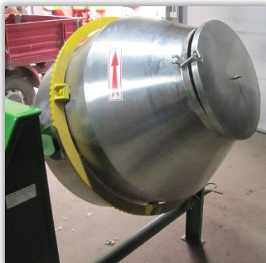
Rys. 73. Komora mieszania zaprawiarki porcjowej-bębnowej.
