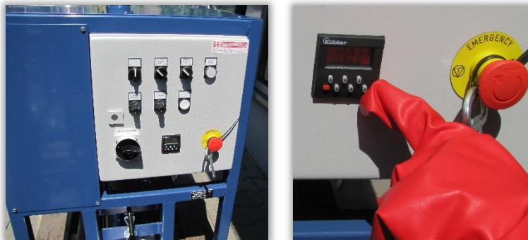
Rys. 49 i 50. Licznik cykli podawania nasion umiejscowiony na tablicy rozdzielczej zaprawiarki przepływowej.
