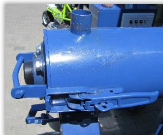
Rys. 63. Przewody łączące zaprawiarkę z urządzeniem odpylającym. Rys. 64. Otwór przyłącza urządzenia odpylającego do komory mieszania.
