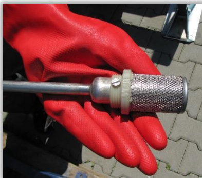
Rys. 57. Filtr ssawny z elastycznym przewodem cieczowym.
