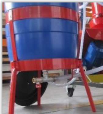
Rys. 26. Zbiornik zaprawy z pokrywą stojący na ramie zaprawiarki.
