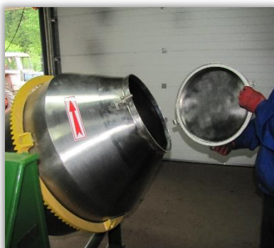
Rys. 28 i 29. Pokrywa zewnętrzna (28) i wewnętrzna (29) bębna zaprawiarki porcjowej.
