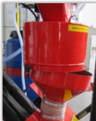
Rys. 74 i 75. Komory zraszania z rotacyjnym elementem zraszającym: uchylona osłona (74) i wnętrze komory po zdjęciu osłony (75).
