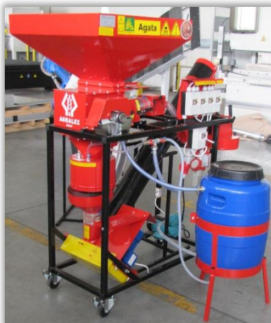
Rys. 11 i 12. Zaprawiarki przepływowe stosowane do zaprawiania zaprawą w formie płynnej.
