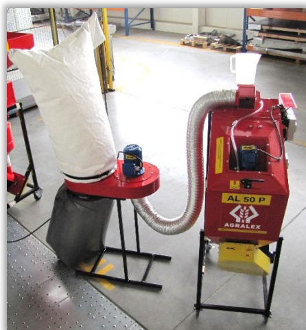
Rys. 4. Zaprawiarka porcjowa i dedykowany system odpylania.
