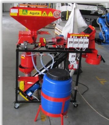
Rys. 51. Przewody cieczowe łączące układ czerpakowy ze zbiornikiem zaprawy.
