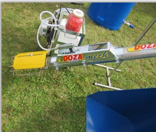
Rys. 32 i 33. Zaprawiarka montowana na przenośniku ślimakowym do zboża - podawanie zaprawy i zraszanie ciśnieniowe.
