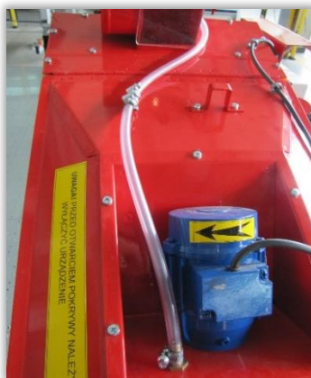
Rys. 22 i 23. Silnik elektryczny napędzający bęben zaprawiarki bębnowej (22), lub napędzający rozpylacz rotacyjny zaprawiarki porcjowej (23).
