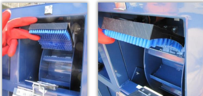
Rys. 36 i 37. Szczotki wyrównujące napełnienie komór porcjujących nasiona.
