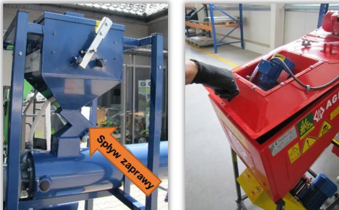
Rys. 78. Komora zraszania z grawitacyjnym spływem zaprawy - zaprawa jest „zabierana” przez nasiona na specjalnie ukształtowanej powierzchni.
