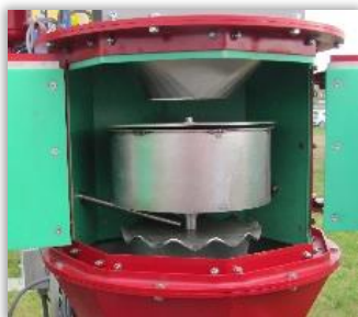
Rys. 53 i 54. Komora zraszania zaprawiarki przepływowej z otwartą osłoną (53) i ze zdemontowaną osłoną (54).
