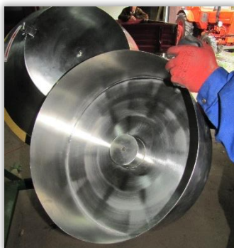
Rys. 28 i 29. Pokrywa zewnętrzna (28) i wewnętrzna (29) bębna zaprawiarki porcjowej.
