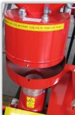
Rys. 55. Komora zraszania zaprawiarki przepływowej z częściowo zdemontowaną dolną osłoną.
