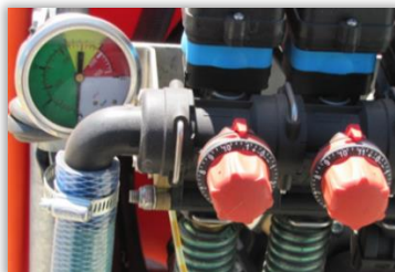
Rys. 44. Zawory kompensacyjne opryskiwacza sadowniczego z oznaczeniem pozycji ustawienia zaworu.
