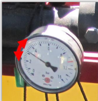
Rys. 41. Manometr z zaznaczonym zakresem drgań wskazówki.
