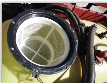
Rys. 19. Sito wlewowe bez rozwadniacza preparatów.
