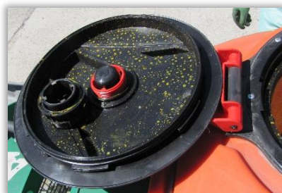
Rys. 25. Elementy ruchome zaworu napowietrzającego zbiornik.
