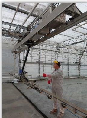
Rys. 63. Korba ręcznej regulacji wysokości belki opryskowej.
