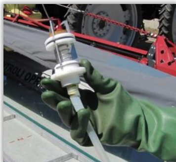
Rys. 83 i 84. Adapter umożliwiający szczelne połączenie rozpylacza z urządzeniem pomiarowym zbierającym ciecz.
