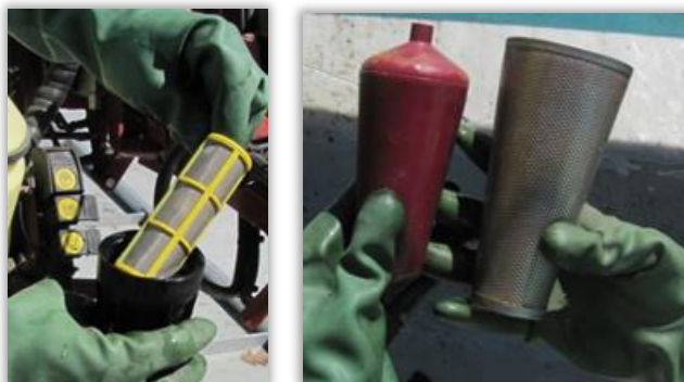
Rys. 56 i 57. Kontrola stanu technicznego i parametrów wkładu filtracyjnego.
