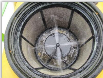
Rys. 50. Rozwadniacz zamontowany w sicie wlewowym zbiornika opryskiwacza.
