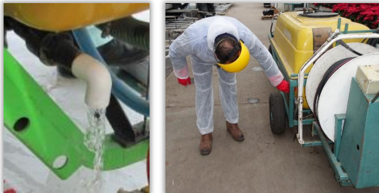
Rys. 20 i 21. Zawór spustowy układu opróżniania opryskiwacza i umiejscowienie zaworu w zbiorniku opryskiwacza.
