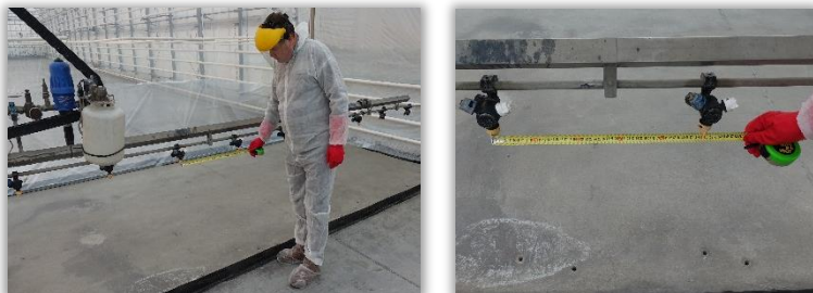
Rys. 69 i 70. Pomiar odległości między rozpylaczami na belce.
