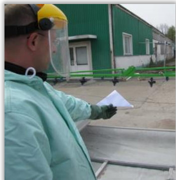
Rys. 79. Ocena jednorodności kąta rozpylania z wykorzystaniem papierowego wzorca.
