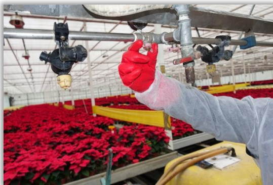
Rys. 43. Zawór odcinający dopływ cieczy do części belki opryskowej.
