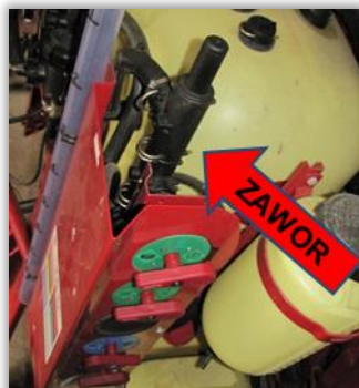
Rys. 33. Zawór bezpieczeństwa montowany w bezpośrednim sąsiedztwie układu zaworów (opryskiwacz polowy).
