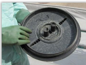
Rys. 16. Zawór napowietrzający pokrywy zbiornika.
