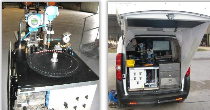
Rys. 85 i 86. Stanowisko do pomiaru natężenia wypływu cieczy z rozpylaczy zdemontowanych z opryskiwacza oraz mobilna stacja kontroli (Francja).
