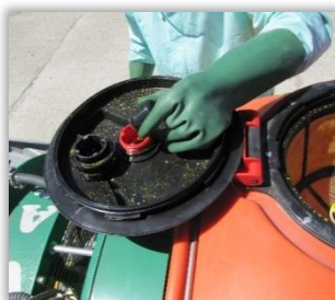
Rys. 26. Sprawdzanie drożności zaworu napowietrzającego.
