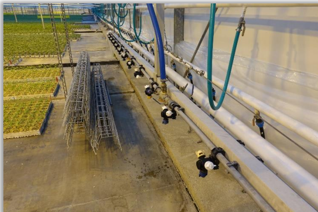
Rys. 68. Pozycja spoczynkowa belki nawodnieniowo-opryskowej.
