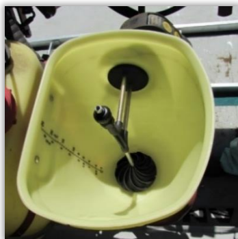
Rys. 51. Rozwadniacz boczny montowany obok zbiornika.
