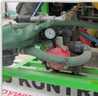
Rys. 30. Sprawdzenie ciśnienia w powietrzniku przy użyciu podręcznego manometru.
