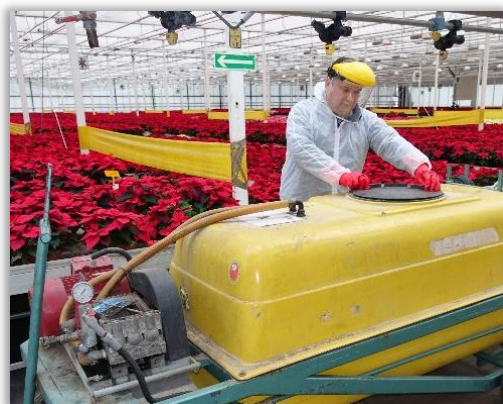
Rys. 15. Pokrywa zbiornika uszczelniana przez ich obrót.
