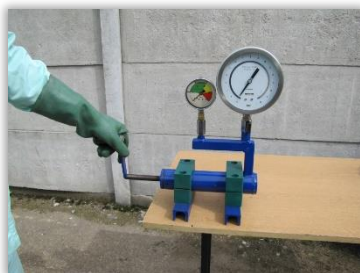
Rys. 39. Pomiar błędu ciśnienia wskazywanego przez manometr opryskiwacza na stanowisku kontrolnym wyposażonym w prasę hydrauliczną i manometr kontrolny.
