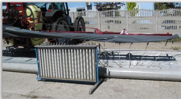
Rys. 82. Urządzenie do pomiaru natężenia wypływu cieczy z 20 rozpylaczy jednocześnie. Wyposażone jest w zestaw 20 menzur o pojemności 2000 ml połączonych w sposób umożliwiający jednoczesne rozpoczęcie lub zakończenie napełniania tych menzur ( pomiar na opryskiwaczu polowym).
