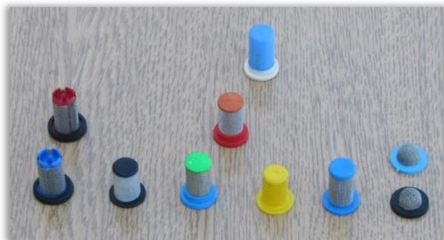
Rys. 78. Różne typy i rozmiary filtrów rozpylaczy. Kolor jednakowego typu filtra oznacza gęstość siatki (liczba mesh).
