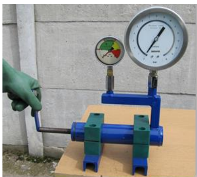
Rys. 90. Stanowisko kontrolne do sprawdzania manometru opryskiwacza.
