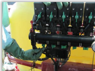
Rys. 45. Zawory kompensacyjne opryskiwacza polowego.
