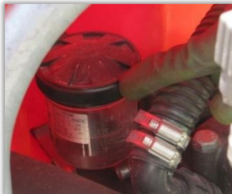
Rys. 29. Zbiornik wskaźnikowy poziomu oleju w pompie przeponowej opryskiwacza.
