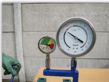
Rys. 40. Pomiar dokładności wskazań manometru na stanowisku kontrolnym przy ciśnieniu 5 barów.
