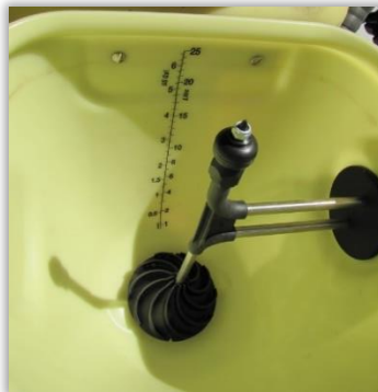
Rys. 53. Płuczka opakowań po środkach ochrony montowana w rozwadniaczu bocznym opryskiwacza.
