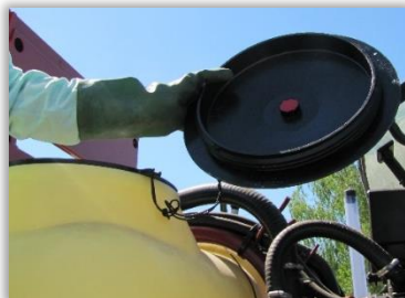
Rys. 14. Mocowanie pokrywy za pomocą linki.
