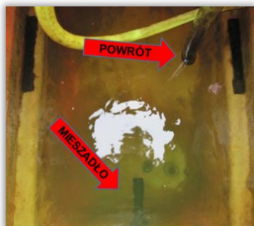
Rys. 23. Mieszadło hydrauliczne i przewód powrotny do zbiornika.
