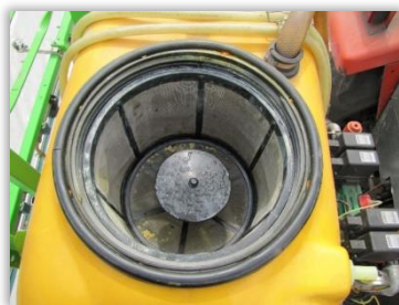
Rys. 18. Sito z rozwadniaczem preparatów w otworze wlewowym opryskiwacza.
