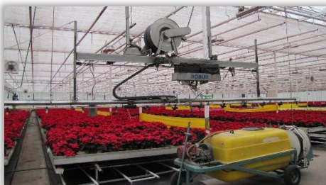
Rys. 48. Urządzenie do zwijania przewodu dostarczającego ciecz do belki.
