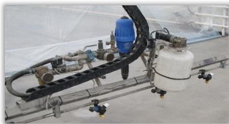
Rys. 34. Dozownik nawozów stosowany w systemach iniekcyjnych i zbiornik na środek ochrony roślin.
