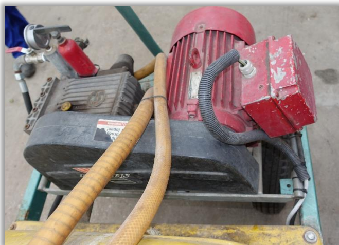
Rys. 2. Osłona napędu pompy - napęd od silnika elektrycznego.
