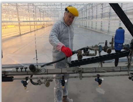
Rys. 47. Sprawdzanie jakości połączeń układu cieczowego w opryskiwaczu szklarniowym.
