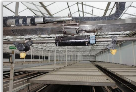
Rys. 73. Mechanizm regulacji kierunku ustawienia rozpylaczy – spiralna prowadnica zamontowana do belki zmienia ruch posuwisty siłownika na obrotowy ruch belki z rozpylaczami.
