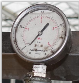
Rys. 37. Manometr o zakresie wskazań do 40 barów.
