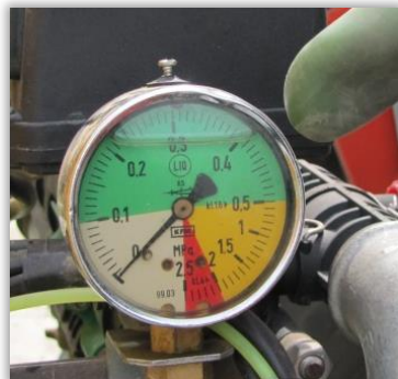
Rys. 42. Manometr glicerynowy - wskazówka jest zanurzona w glicerynie tłumiącej drgania.
