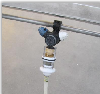
Rys. 83 i 84. Adapter umożliwiający szczelne połączenie rozpylacza z urządzeniem pomiarowym zbierającym ciecz.
