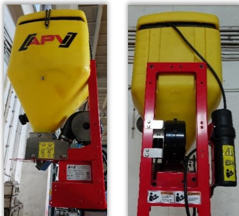
Rys. 10 i 11. Osłona wentylatora układu pneumatycznego w rozsiewaczu rzędowym.
