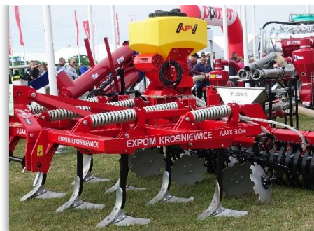
Rys. 13. Miejsce zamontowania zbiornika sprzętu do aplikacji ś.o.r. w formie granulatu na narzędziu uprawowym.
