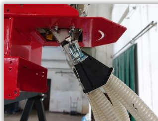
Rys. 16 i 17. Miejsce połączenia ze zbiornikiem przewodów rozprowadzających granulat (rozdzielacz granulatu).
