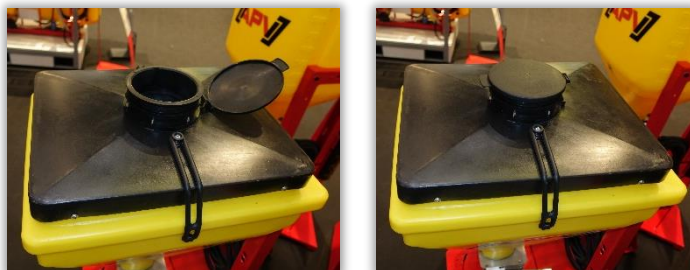
Rys. 26 i 27. Urządzenie do bezpiecznego napełniania zbiornika zamontowane w pokrywie zbiornika zabezpieczonej przed otwarciem gumową zapinką.
