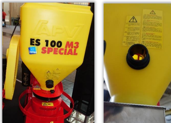
Rys. 28 i 29. Prosty zawór spustowy układu opróżniania zbiornika z granulatu.
