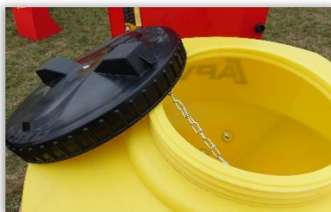
Rys. 24 i 25. Pokrywa zbiornika uszczelniana przez obrót, mocowana za pomocą łańcuszka (po lewej) i gumowa pokrywa zbiornika, wciskana w otwór zasypowy (po prawej).
