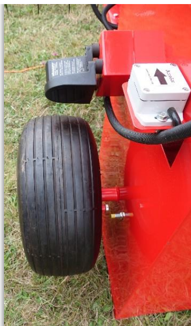
Rys. 50. Impulsowy czujnik prędkości (montowany na kole i na elemencie nieruchomym) i czujniki do pomiaru prędkości: radarowego (czarna obudowa) oraz w oparciu o sygnał GPS (biała obudowa) - stanowisko demonstracyjne.
