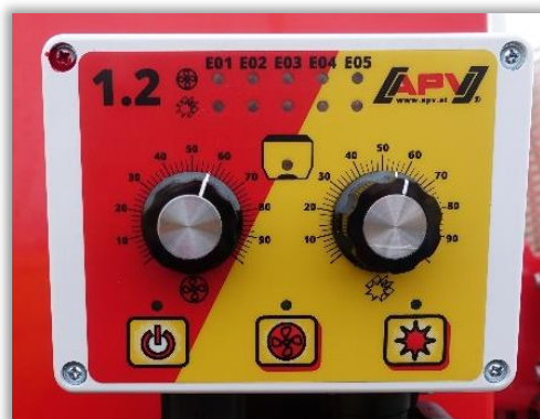
Rys. 36. Panel regulacyjny prędkości obrotowej wałka wysiewającego i tarczy rozsiewającej.
