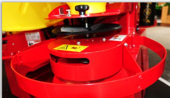
Rys. 6. Tarcza wysiewająca granulat z łopatkami wysiewającymi.
