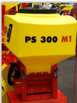
Rys. 30. Umieszczenie pokrywy do próby wysiewu, po zdemontowaniu płyty możliwe jest opróżnianie zbiornika.
