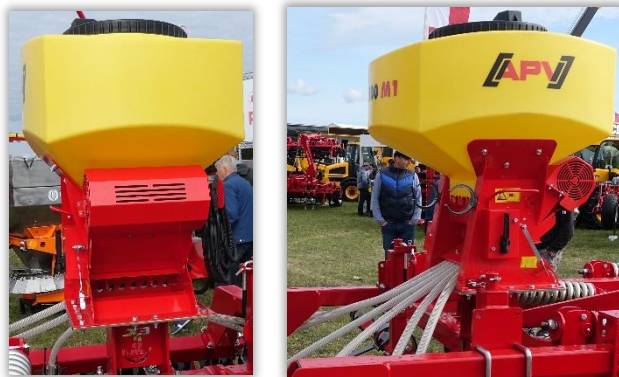
Rys. 8 i 9. Osłona dmuchawy elektrycznej.
