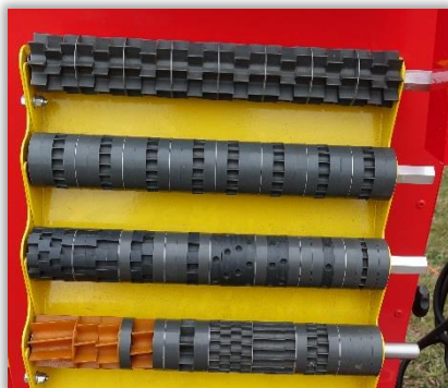
Rys. 3. Wálki wysiewające z zamontowanymi na nich kołami wysiewającymi o różnym kształcie i zastosowaniu (wysiew nasion o różnych rozmiarach lub granulatów w różnych dawkach).
