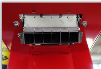
Rys. 16 i 17. Miejsce połączenia ze zbiornikiem przewodów rozprowadzających granulat (rozdzielacz granulatu).
