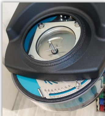
Rys. 38 i 39. Regulacja miejsca opadania granulat na tarczę wysiewającą – regulacja zasięgu, symetrii i rozkładu wysiewanego granulat.
