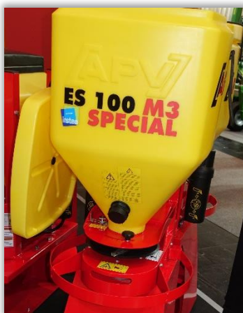
Rys. 2. Aplikator granulatu rzutowy (powierzchniowy).
