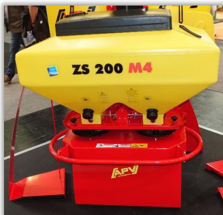
Rys. 4. Rzutowy rozsiewacz granulowanych ś.o.r. (z tarczami wysiewającymi) do zwalczania ślimaków.
