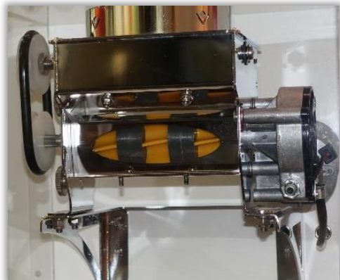
Rys. 37. Stanowisko demonstracyjne mechanizmu napędowego wałka wysiewającego z zamontowanymi na nim kołami wysiewającymi.
