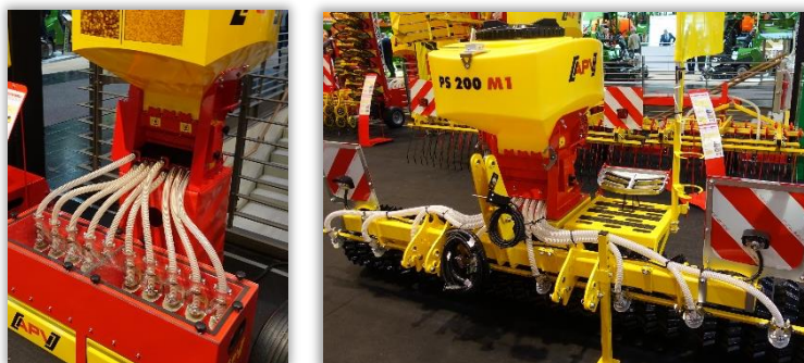
Rys. 45 i 46. Płytki wysiewające na stanowisku demonstracyjnym i zamontowane na narzędziu uprawowym (po prawej).
