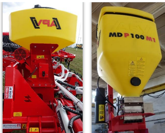
Rys. 18 i 19. Oględziny zbiornika na środek ochrony roślin – miejsce połączenia zbiornika z elementem nośnym i miejsce zamontowania zaworu spustowego.
