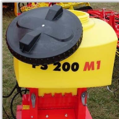
Rys. 15. Pokrywa i ściany zewnętrzne zbiornika - miejsca narażone na zanieczyszczenie.
