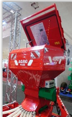
Rys. 22 i 23. Pokrywa zbiornika zabezpieczona zamkiem przed przypadkowym otwarciem (po lewej) i pokrywa z zawiasem stabilizującym (po prawej).
