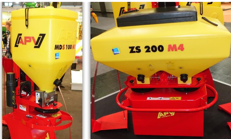
Rys. 41 i 42. W rozsiewaczach tarczowych, tarcza lub tarcze wysiewające znajdują się w pobliżu układu dozującego.
