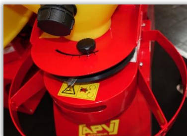
Rys. 38 i 39. Regulacja miejsca opadania granulat na tarczę wysiewającą – regulacja zasięgu, symetrii i rozkładu wysiewanego granulat.
