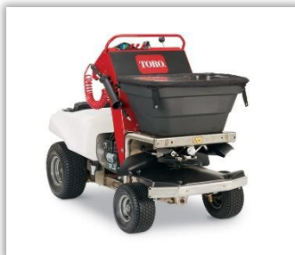
Rys. 12 i 13. Kombinacja rozrzutnika (np. nawozów) z opryskiwaczem z przeznaczeniem do pielęgnacji terenów przydomowych (wysiew nasion, nawożenie i ochrona trawników), ze zbiornikiem 40 l – podlega obowiązkowi badania stanu technicznego [Źródło: Internet 11, 12].
