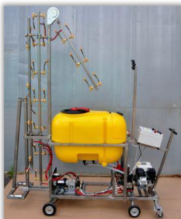
Rys. 6 i 7. Robot opryskowy do szklarni i opryskiwania na zewnątrz – zbiornik 200 l [Źródło: Internet 5, 6].
