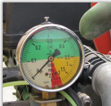
Rys. 56. Manometr glicerynowy - wskazówka jest zanurzona w glicerynie tłumiącej drgania.
