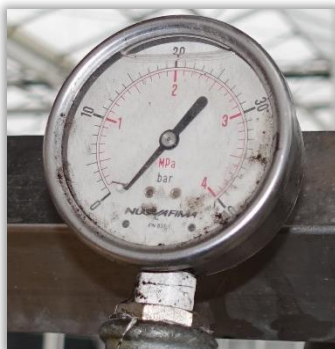
Rys. 49. Manometr o zakresie wskazań do 40 barów / 4,0 MPa.
