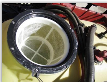
Rys. 32. Sito wlewowe bez rozwadniacza preparatów.
