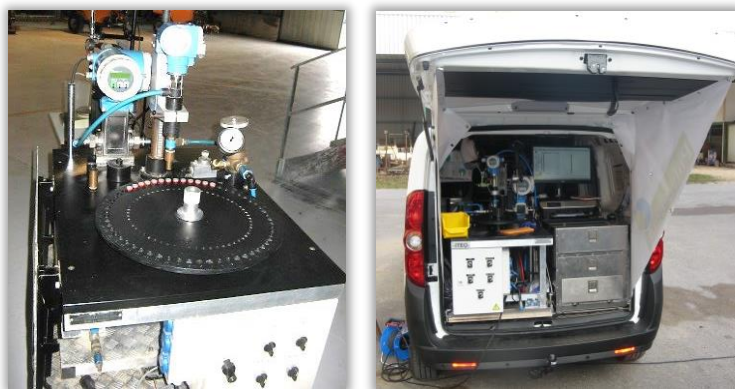
Rys. 76 i 77. Stanowisko do pomiaru natężenia wypływu cieczy z rozpylaczy zdemontowanych z opryskiwacza oraz mobilna stacja kontroli (Francja).
