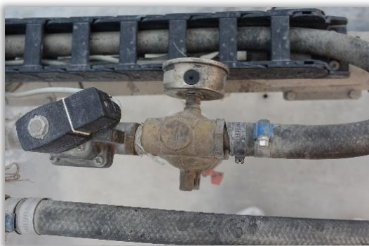
Rys. 57. Miejsca połączeń układu cieczowego.
