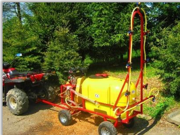
Rys. 9. Opryskiwacz specjalistyczny ze zbiornikiem 200 l – podlega obowiązkowi badania stanu technicznego [Źródło: Internet 8].
