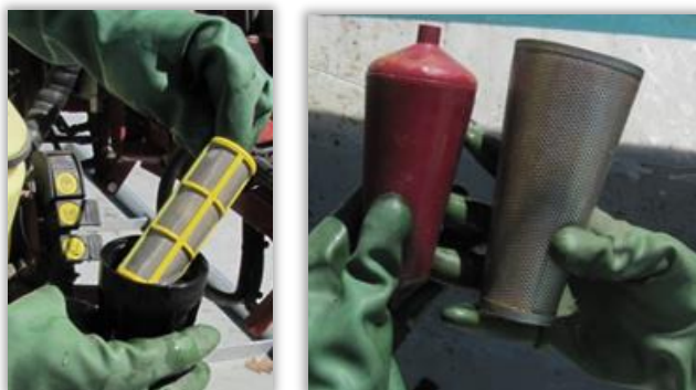
Rys. 70 i 71. Kontrola stanu technicznego i parametrów wkładu filtracyjnego.
