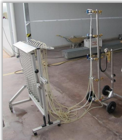
Rys. 81. Pionowa belka opryskowa i pomiar wydatku cieczy z rozpylaczy.
