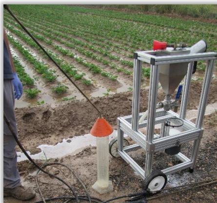
Rys. 78. Pomiar wydatku rozpylacza zamontowanego na lancy opryskowej z wykorzystaniem menzury pomiarowej. Obok specjalne urządzenie do pomiaru wydatku cieczy z lanc opryskowych wyposażone w specjalną osłonę i menzurę pomiarową.
