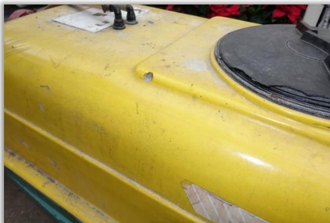
Rys. 25. Drobne uszkodzenia pokrywy zbiornika na ciecz użytkową.
