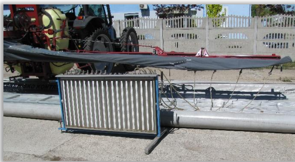
Rys. 73. Urządzenie do pomiaru natężenia wypływu cieczy z 20 rozpylaczy jednocześnie (tu: pomiar na opryskiwaczu polowym).
