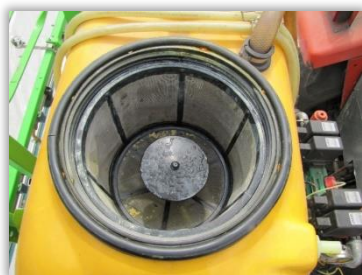
Rys. 31. Sito z rozwadniaczem preparatów w otworze wlewowym opryskiwacza.
