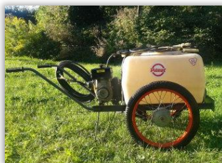
Rys. 3 i 4. Opryskiwacz taczkowy spalinowy, zbiornik 125 l [Źródło: Internet 2, 3].
