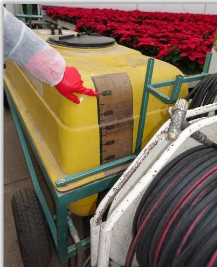
Rys. 36. Wskaźnik poziomu cieczy i bęben z nawiniętym przewodem cieczowym zakończonym pistoletem opryskowym.
