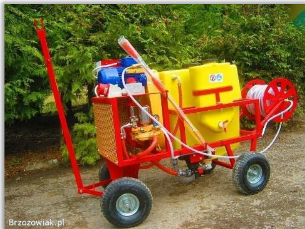
Rys. 8. Opryskiwacz specjalistyczny wózkowy ze zbiornikiem 80 l – podlega obowiązkowi badania stanu technicznego [Źródło: Internet 7].
