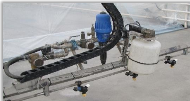
Rys. 45. Dozownik nawozów stosowany w systemach iniekcyjnych (niebieski) i zbiornik na środek ochrony roślin.
