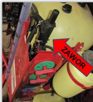
Rys. 44. Zawór bezpieczeństwa montowany w bezpośrednim sąsiedztwie układu zaworów (opryskiwacz polowy).
