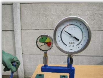
Rys. 54. Pomiar dokładności wskazań manometru na stanowisku kontrolnym przy ciśnieniu 5 barów.
