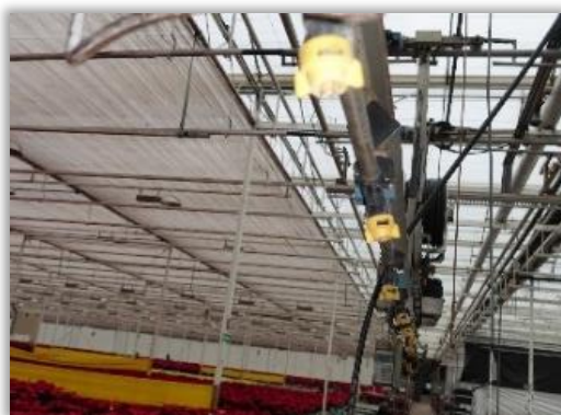
Rys. 79. Przy ocenie wizualnej jednolite rozpylacze powinny mieć jednolite kołpaki dla ich łatwej identyfikacji.
