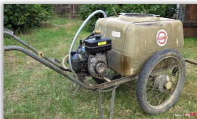
Rys. 3 i 4. Opryskiwacz taczkowy spalinowy, zbiornik 125 l [Źródło: Internet 2, 3].
