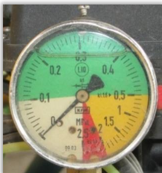
Rys. 48. Manometr zalecany do pracy w zakresie do 0,5 MPa (5 barów).
