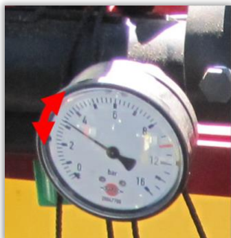
Rys. 55. Manometr z zaznaczonym zakresem drgań wskazówki.
