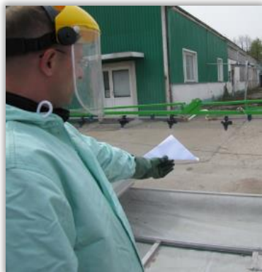
Rys. 80. Ocena jednorodności kąta rozpylania z wykorzystaniem papierowego wzorca.
