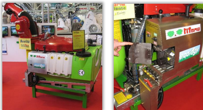
Rys. 46 i 47. Opryskiwacz z systemem iniekcji środka ochrony roślin – możliwe stosowanie do trzech preparatów jednocześnie – wykorzystanie np. w zieleni miejskiej.
