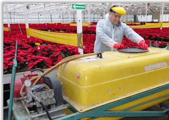
Rys. 26. Pokrywa zbiornika uszczelniana przez jej obrót.
