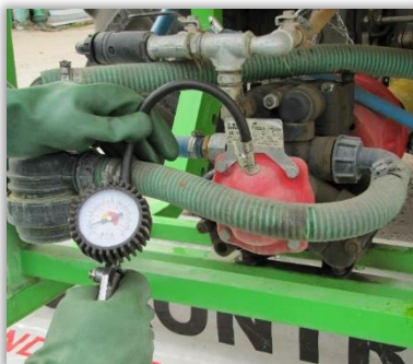
Rys. 39. Sprawdzenie ciśnienia w powietrzniku za pomocą manometru zamontowanego na przewodzie ciśnieniowym pompki lub sprężarki.
