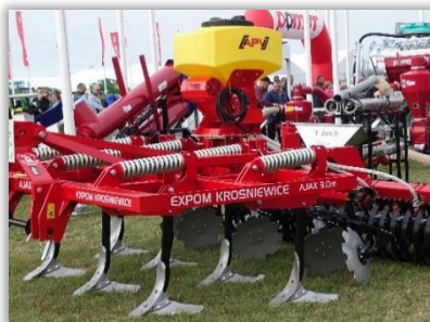
Rys. 15. Miejsce zamontowania zbiornika sprzętu do aplikacji ś.o.r. w formie granulatu na narzędziu uprawowym.
