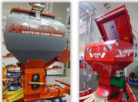
Rys. 22 i 23. Pokrywa zbiornika zabezpieczona zamkiem przed przypadkowym otwarciem (po lewej) i pokrywa z zawiasem stabilizującym (po prawej).
