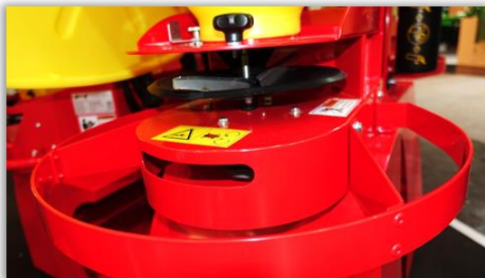
Rys. 5. Tarcza wysiewająca granulę z łopatkami wysiewającymi.
