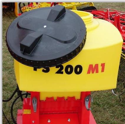
Rys. 17. Pokrywa i ściany zewnętrzne zbiornika - miejsca narażone na zanieczyszczenie.
