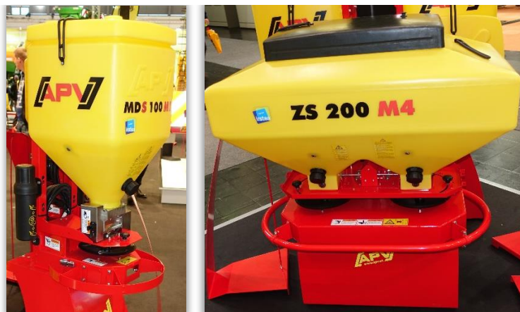
Rys. 41 i 42. W rozsiewaczach tarczowych, tarcza wysiewająca znajduje się w pobliżu układu dozującego.
