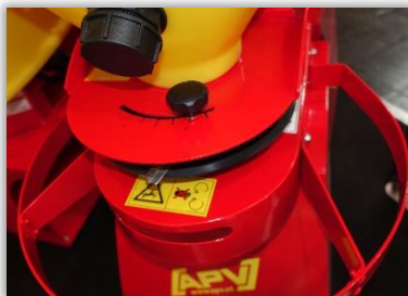
Rys. 38 i 39. Regulacja miejsca opadania granulatu na tarczę wysiewającą – regulacja zasięgu, symetrii i rozkładu wysiewanego granulatu.
