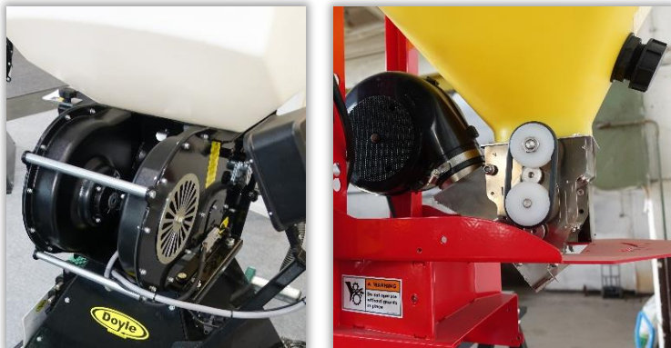
Rys. 47 i 48. Wentylatory rozsiewaczy pneumatycznych. Po prawej (rys. 48) widoczny również pasowy napęd wałka wysiewającego.
