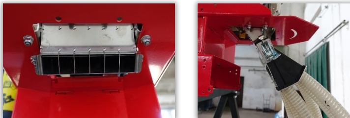
Rys. 20 i 21. Miejsce połączenia ze zbiornikiem przewodów rozpraszających granulaty (rozdzielacz granulatu).
