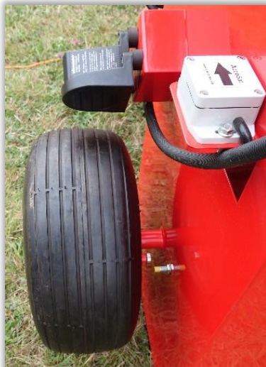
Rys. 50. Impulsowy czujnik prędkości (montowany na kole i na elemencie nieruchomym) i czujniki do pomiaru prędkości: radarowego (czarna obudowa) oraz w oparciu o sygnał GPS (biała obudowa) - stanowisko demonstracyjne.
