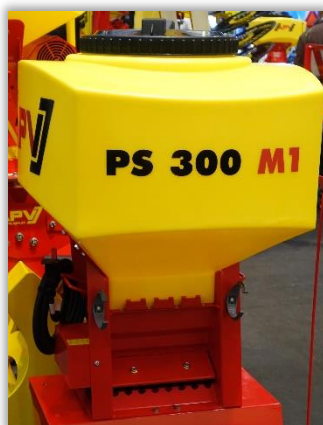
Rys. 30. Umieszczenie pokrywy do próby wysiewu, po zdemontowaniu płyty możliwe jest opróżnianie zbiornika.
