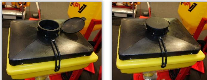
Rys. 26 i 27. Urządzenie do bezpiecznego napełniania zbiornika zamontowane w pokrywie zbiornika zabezpieczonej gumową zapinką przed otwarciem.
