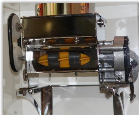
Rys. 37. Stanowisko demonstracyjne mechanizmu napędowego wałka wysiewającego z zamontowanymi na nim kołami wysiewającymi. Napęd elektryczny.
