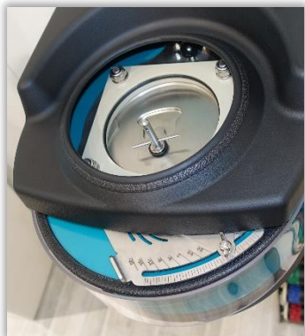
Rys. 38 i 39. Regulacja miejsca opadania granulatu na tarczę wysiewającą – regulacja zasięgu, symetrii i rozkładu wysiewanego granulatu.
