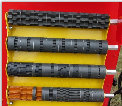
Rys. 1. Wałki wysiewające z zamontowanymi na nich kołami wysiewającymi o różnym kształcie i zastosowaniu (wysiew nasion o różnych rozmiarach lub granulatów w różnych dawkach).
