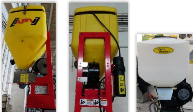
Rys. 11-13. Osłona wentylatora układu pneumatycznego w rozsiewaczu rzędowym.
