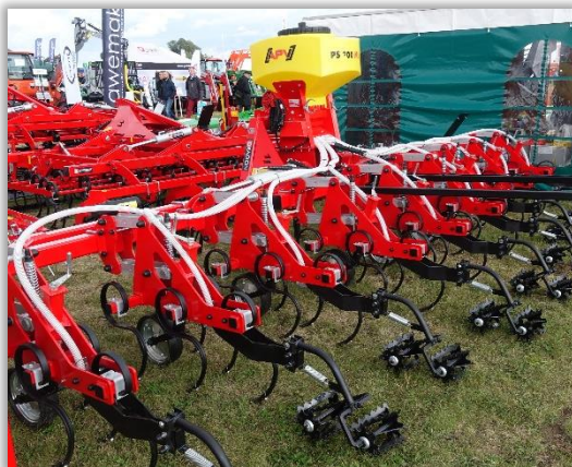
Rys. 7. Rzędy aplikator granulatów z widocznymi (jasnymi) przewodami doprowadzającymi granulaty.
