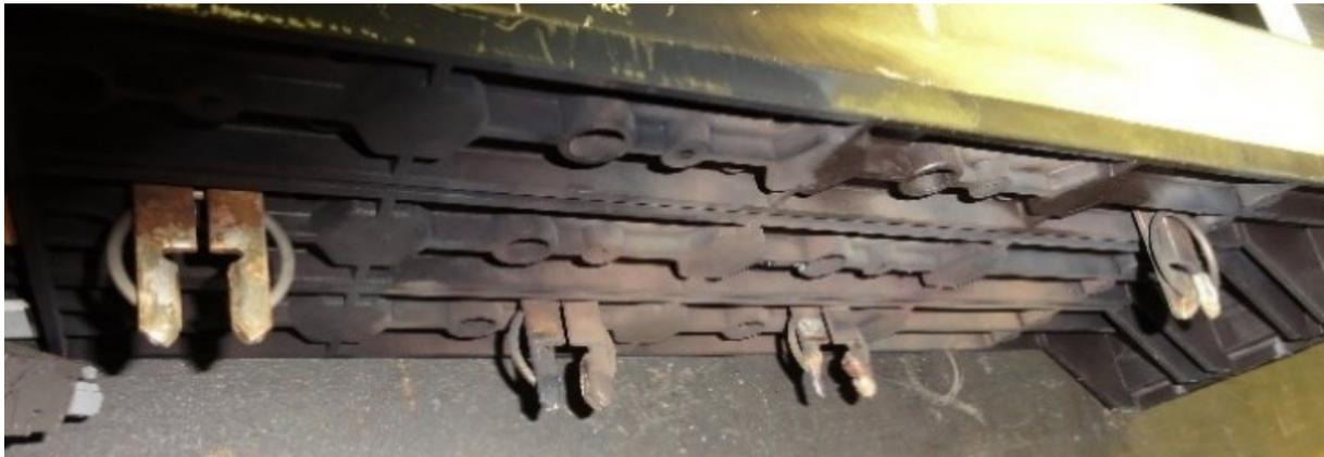
Struttura di base Contatti di serraggio dopo il cortocircuito
