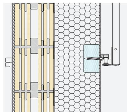
**2** Fissaggio della guida di scorrimento con cilindro di montaggio ZyRillo-EPS Ø 125
