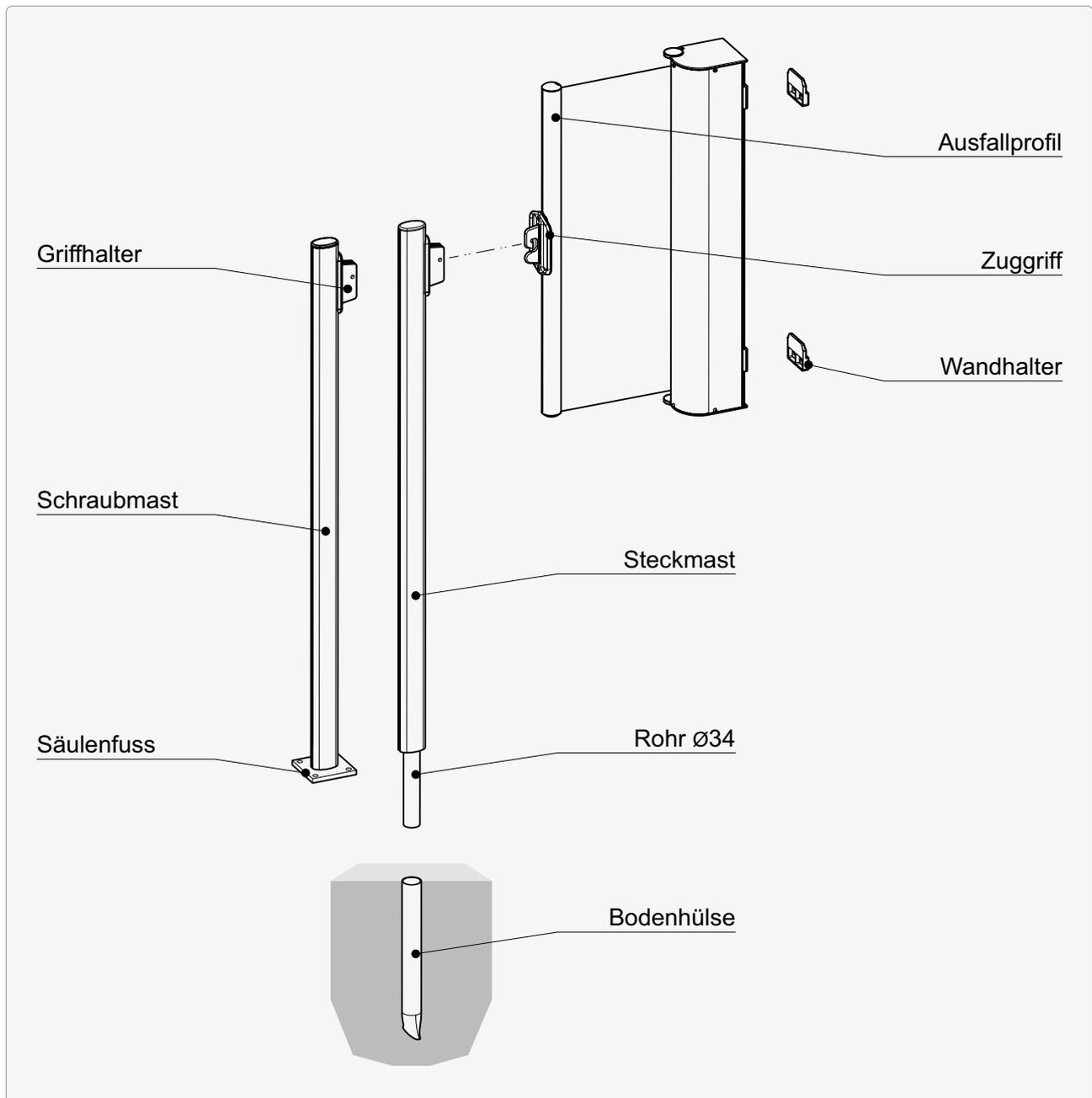
Nach dem Ausziehen des Paravento wird der Griffhalter an einem Schraub- bzw. Steckmast befestigt. Der Schraubmast lässt sich am Boden festschrauben, der Steckmast kann im Boden einbetoniert werden. Es ist erforderlich, beide Masten fest und ein wenig auf Vorspannung zu montieren. So kann der Zug des Tuches ausgeglichen werden.
