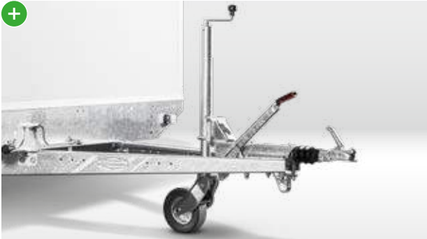
Massives automatisches Stützrad für einen sicheren Stand und schnelles Hochkurbeln.
