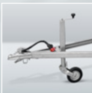
Ungebremster BSX: Deichsel aus U-Profil, freie Länge 135 cm.
