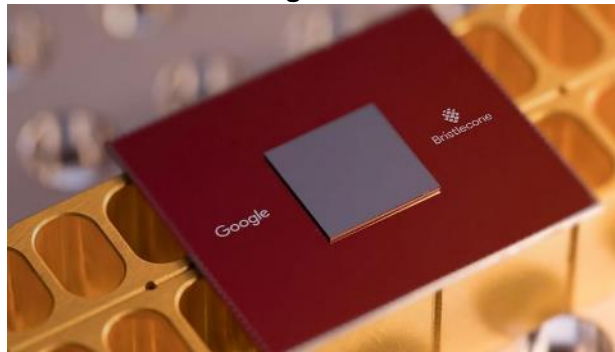
図表 13:72 量子ビットを実現した Google 社の最新量子プロセッサ「Bristlecone」
