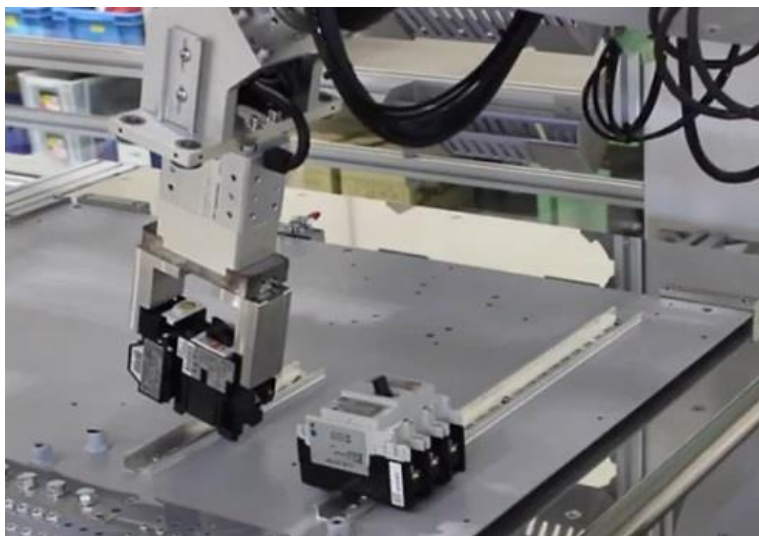
ロボットによる機器の取り付け
