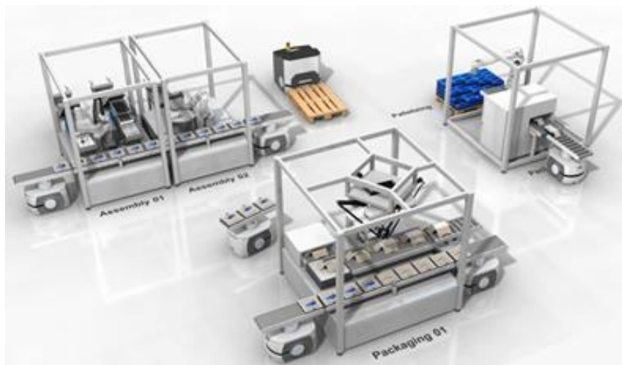
AMR(Autonomous Mobile Robot)による レイアウトフリーの実現 (提供：オムロン)
