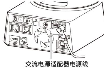
② 将交流电源适配器连接线穿过线夹，然后锁定线夹。
