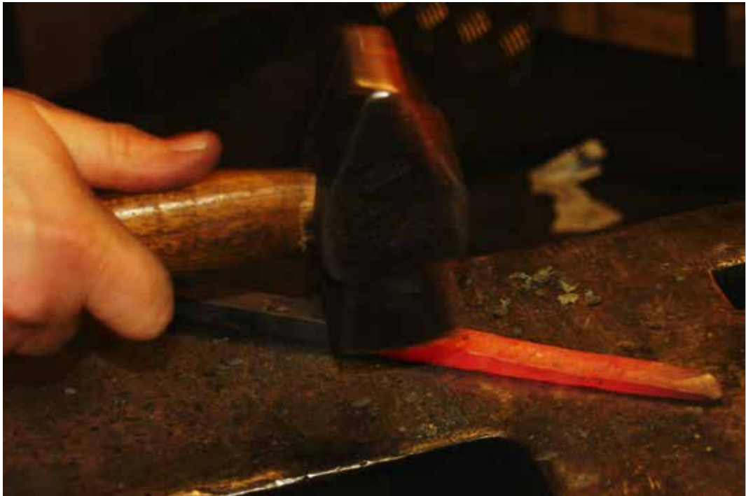
Deutlich erkennbar: Der sogenannte Hammerschlag, Eisen-Flocken, welche bei Erhitzung und nachfolgender Bearbeitung von Eisen entstehen.
