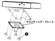
**2.** PSD-10 にマウンティングプレートを固定してください。
