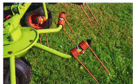
Die Zinkenarme sind gegen die Drehrichtung geknickt. Das erlaubt laut Claas eine um 1 bis 2 km/h höhere Arbeitsgeschwindigkeit.
