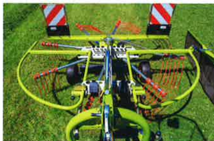
Wie die grossen Schwader von Claas hat auch dieses Einstiegsmodell eine geschlossene, dauergeschmierte Kurvenbahn.
