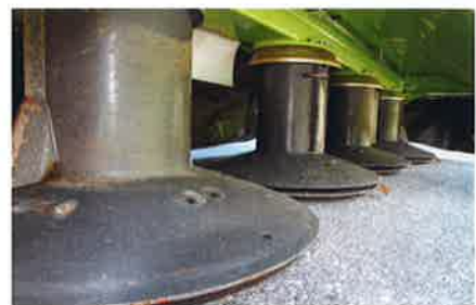
Die «Corto»-Mähwerke haben vier gleich grosse Trommeln mit je drei Klingen und Schnellwechselsystem.
