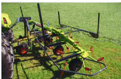
Zwei Feder-Stabilisatoren zentrieren die Zetter beim Ausheben automatisch in die Mittelstellung.
