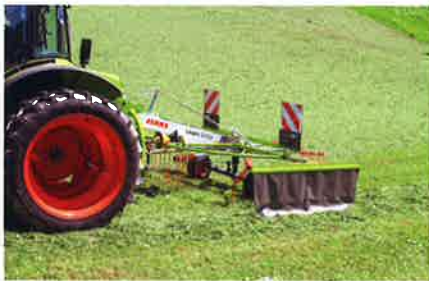
Der Schwader «Liner 320» eignet sich für kleine Flächen und kommt im schwierigen Gelände gut zurecht.
